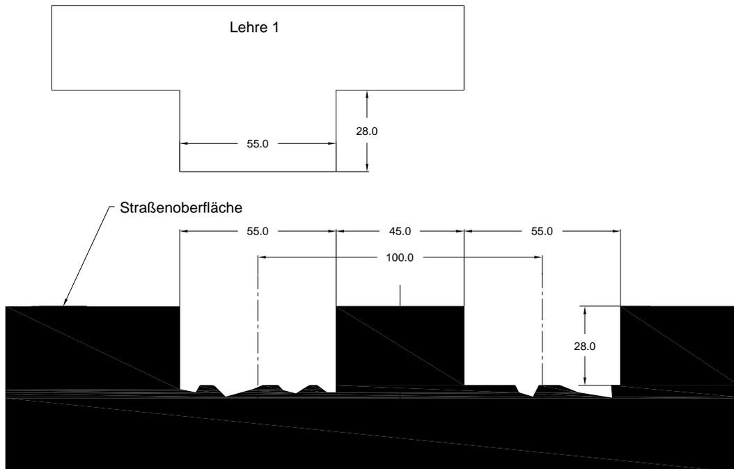
1. Sensorfläche und Zuleitung 28mm tief ausfräsen bzw. ausbrechen. Mit Lehre\_1 prüfen.
