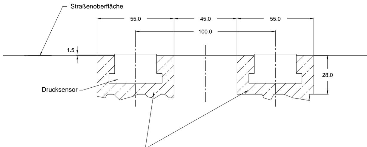
Gießharzmörtel etwa 2,5 Ltr. pro Meter für beide Sensoren, 2Ltr. für Rohre.
