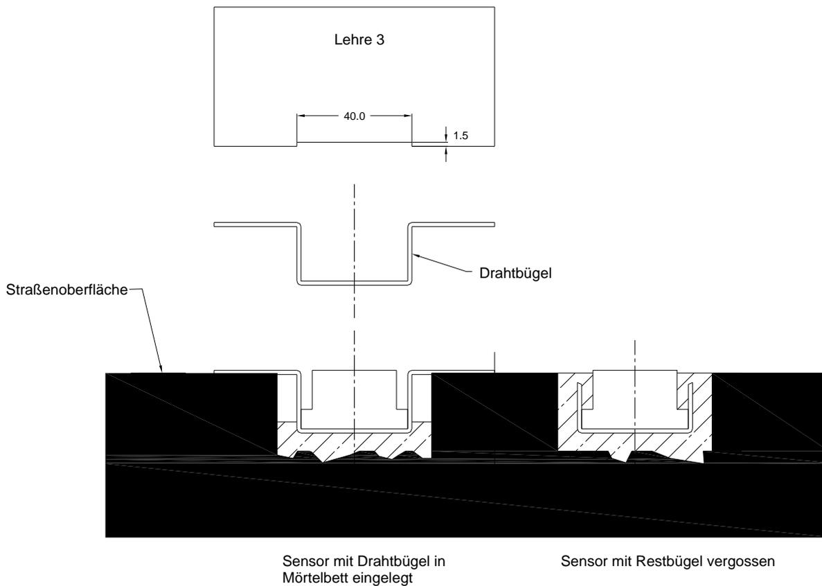
4. Sensor mit 4 Drahtbügel pro Meter einlegen, ausrichten
